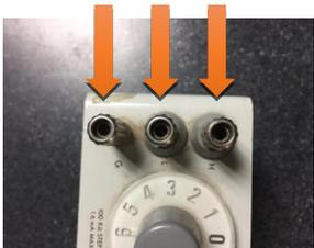
Se colocan puntas banana en las conexiones para poder medir y obtener la resistencia que se busca.
